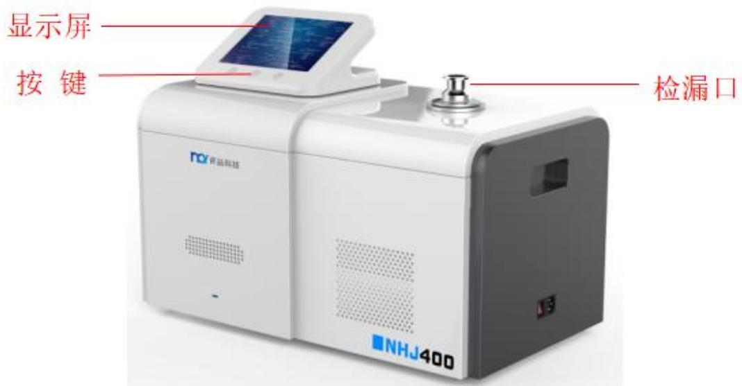
图 7 检漏仪操作面板
