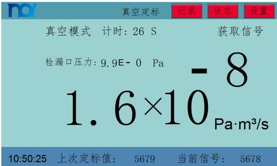
图 16 外置不带开关标漏定标界面
